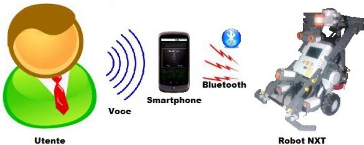
L'utente pronuncia una frase (comando) in prossimità dello smartphone, il riconoscitore Loquendo ASR interpreta l'audio ricevuto e restituisce una stringa di testo che rappresenta la trascrizione di ciò che è stato pronunciato.
